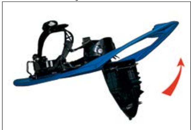
Die doppelte Verwendungsmöglichkeit des Schuhs entsteht durch eine Klappe mit Spikes, die während des Aufstiegs unter dem Schneeschuh befestigt wird und für den nötigen Grip sorgt. Zum Runtergleiten wird die Klappe nach vorn über das Zehenloch gelegt, wodurch eine glatte Fläche an der Unterseite des Schneeschuhs entsteht.
